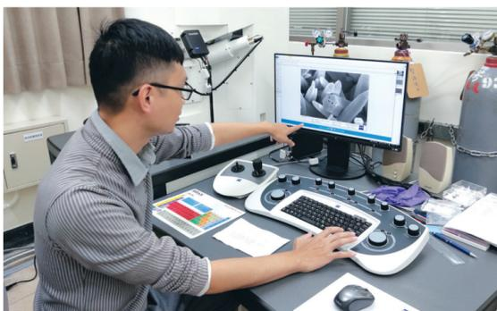
▲化材系技士郭威廷實地操作德國 ZEISS Sigma 300 掃描式電子顯微鏡，可研究奈米化材料型態、分析和鑑定。(攝影/鄧晴)
